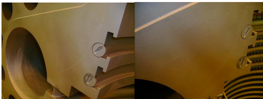
図. 蒸気タービン、ガスタービン、タービンセットに要求される表面品質
